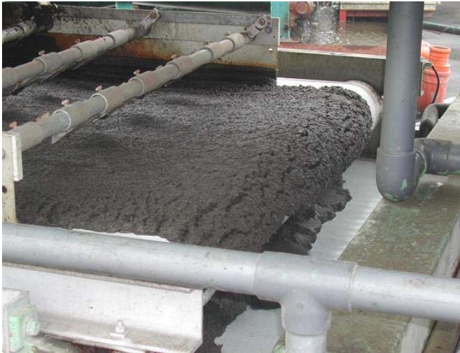
Slammet avvattnades i ett batteri av silbandpressar.
