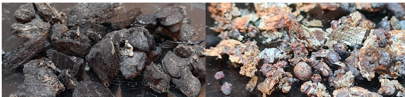
Figur 7. Foton på kol och slaggprodukter som observerats vid analysen av proverna. Materialet på bilderna kommer från två hugg vid station B8.
