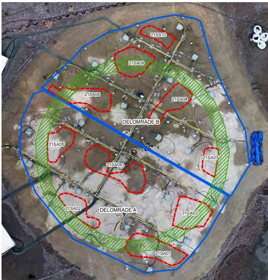
Figur 12 Inför kontroll av resthalter av PAH och bensen i jord delades behandlingsområdet in i två delar, delområde A och B, eftersom åtgärds målet för medelhalt gäller för ett delområde om ca 400 m 2 . I varje delområde placerades därefter ut fem provpunkter (en punkt i varje område som är markerat med rött).
